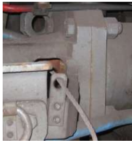
Рис.74 Соединение головки автосцепки с ударно-поглощающим аппаратом
