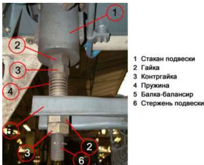
Рис.78 Подвеска автосцепки
