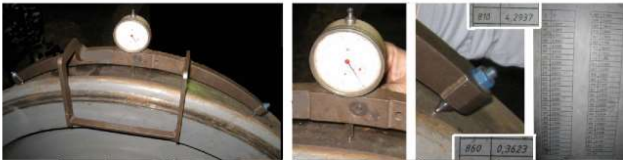
Рис.37 Скоба для измерения диаметра колеса
