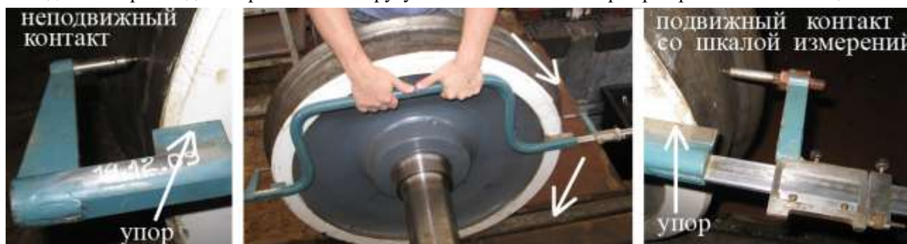
Рис.32 Скоба для измерения диаметра колёс
