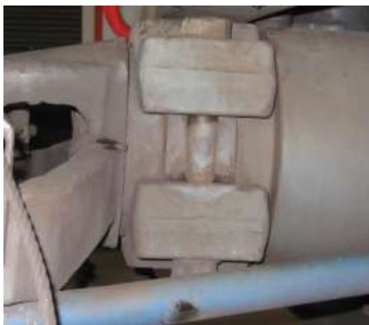
Рис.74 Соединение головки автосцепки с ударно-поглощающим аппаратом
