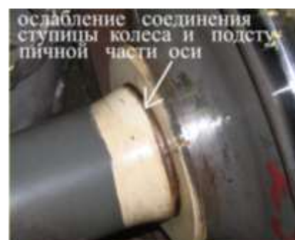
Рис.27 Сдвиг ступицы колеса
