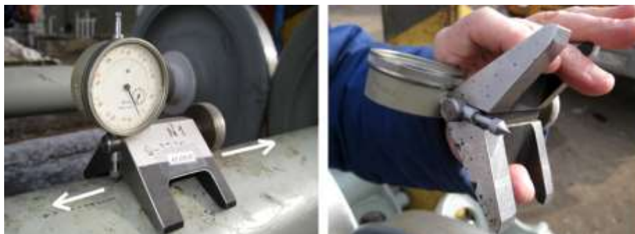
Рис.33 Приспособление для измерения глубины рисок на оси
