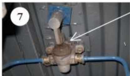
2.3 Клапан вибратора педальный КлЗ типа 144.000 предназначен для обеспечения работы сигнала пневматического С40В, включение клапана производится нажатием на педаль клапана (педаль находится в кабине машиниста)
