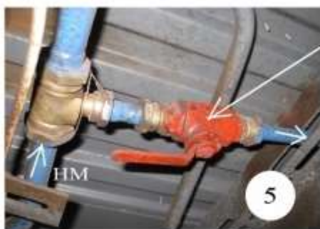
2.1 Разобщительный кран К-27 (двухходовой кран между связкой: кран машиниста и магистралью тифона, расположен под кабиной машиниста слева)
