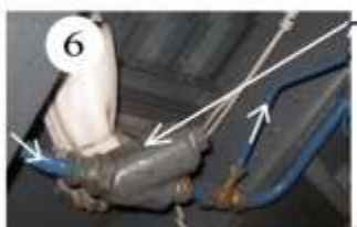
2.1 Разобщительный кран К-27 (двухходовой кран между связкой: кран машиниста и магистралью тифона, расположен под кабиной машиниста слева)
