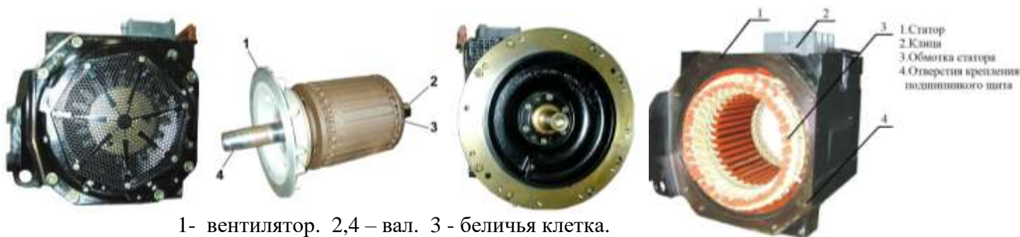
Рис.19. Устройство тягового двигателя
