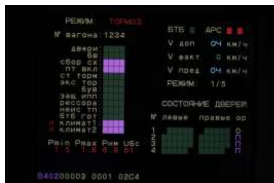
Рис.126 Проверка работы раздвижных дверей
