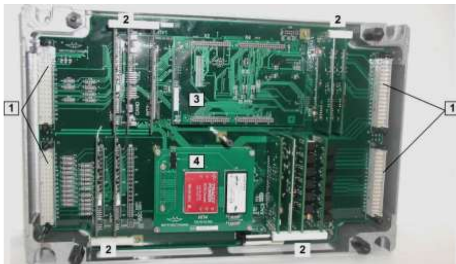
Рис.12 Блок управления тяговым приводом (снята задняя крышка)
