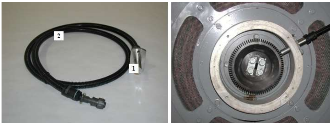
Рис.29 Установка датчика частоты вращения
