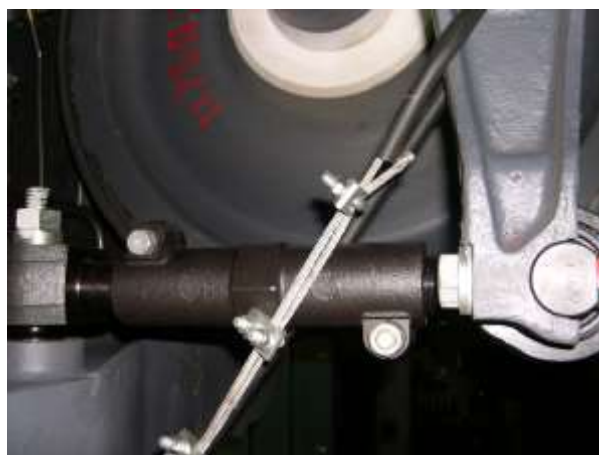
Рис.28 Регулировочная тяга, предохранительный трос
