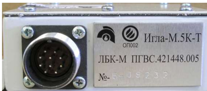
Рис. 78 Локальный блок контроля
