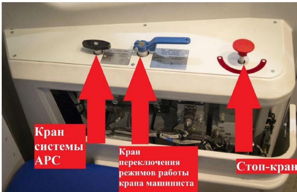
Рис. 16. Пневматические краны в кабине управления
