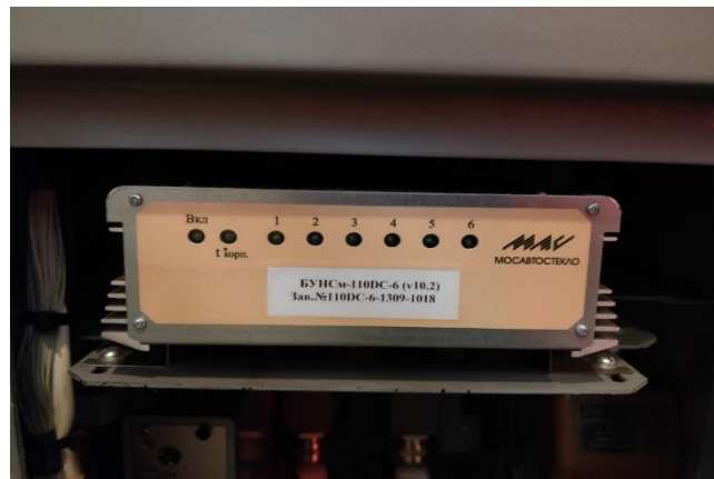
Рисунок 74. Общий вид блока управления нагревом стекол БУНС
