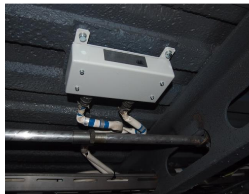
Рисунок 61. Общий вид блока контроля короткого замыкания БККЗ
