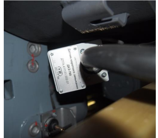
Рисунок 636. Общий вид датчика короткого замыкания ДКЗ
