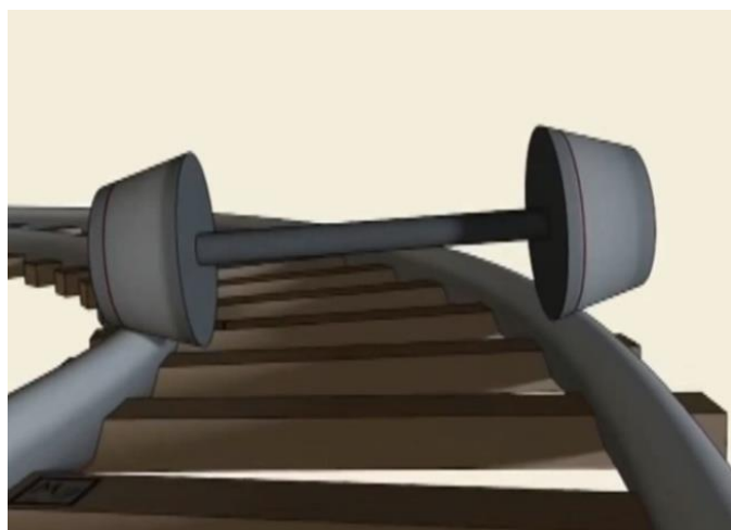
Рис. 69. Движение колесной пары на кривом участке пути
