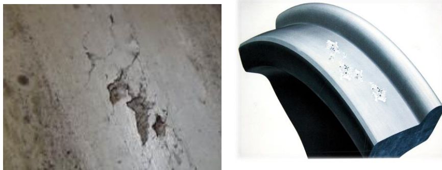
Рис. 72. Выкрашивания металла на поверхности колеса
