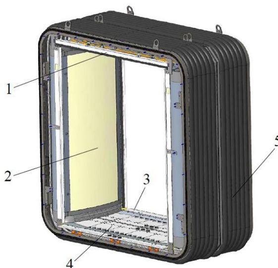
Рис.11. Межвагонный переход (общая конструкция)
