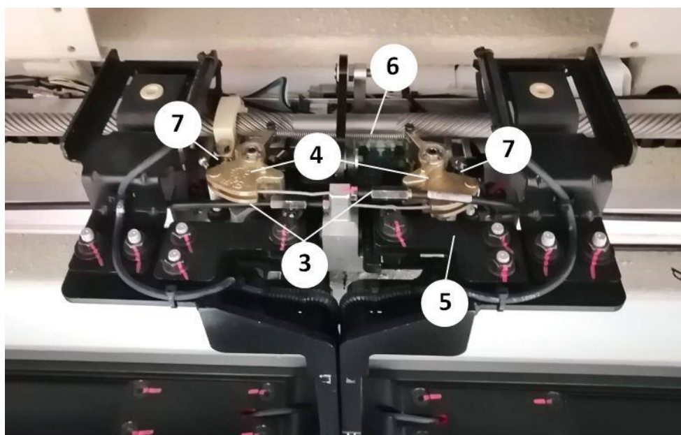
Рис. 34. Устройство аварийного открытия дверей (АОД)
