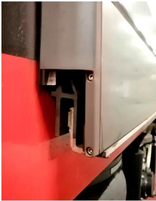
Рис. 28. Верхняя и нижняя подножки дверной створки: 1 – дверная створка; 2 – верхняя подножка; 3 – нижняя подножка; 4 – направляющий рельс дверной створки
