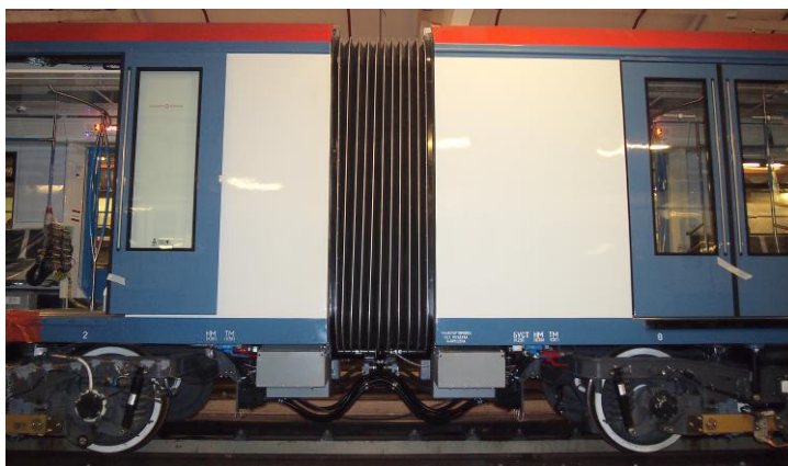
Рис. 10. Межвагонный переход (вид снаружи)
