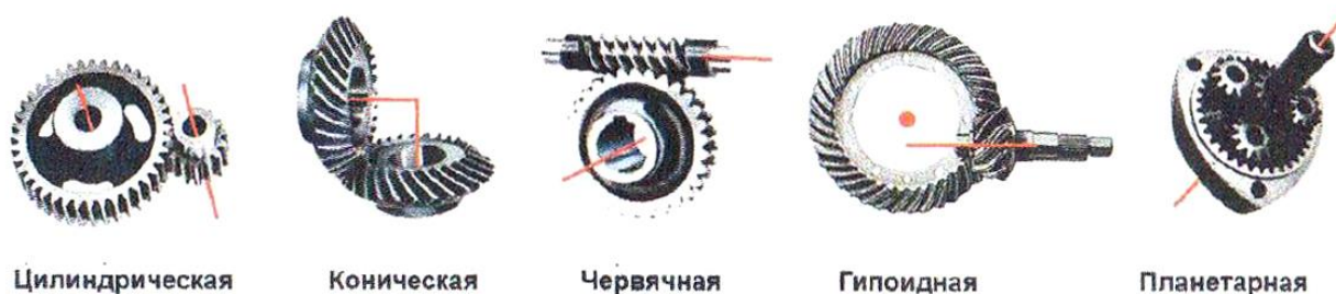
Рис. 87. Основные типы механических передач
