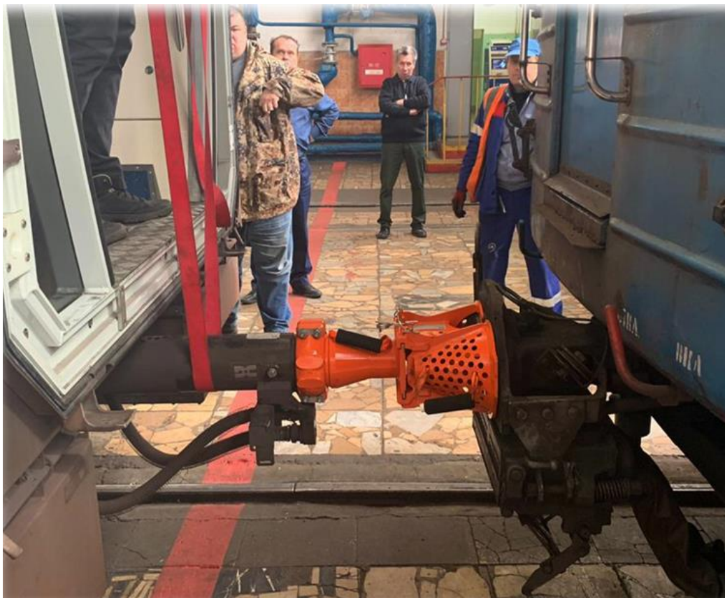
Рис. 146. Адаптер в сцепленном состоянии с головкой Шарфенберга
